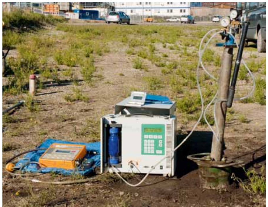
Messsystem bestehend aus Packersonde, Pumpe und Deponiegasanalytator
