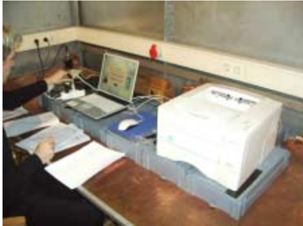
Bild 3-5: Anordnung für den Test gegen HF-Ströme
