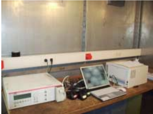
Bild 3-4: Testaufbau für den Surge-Test
