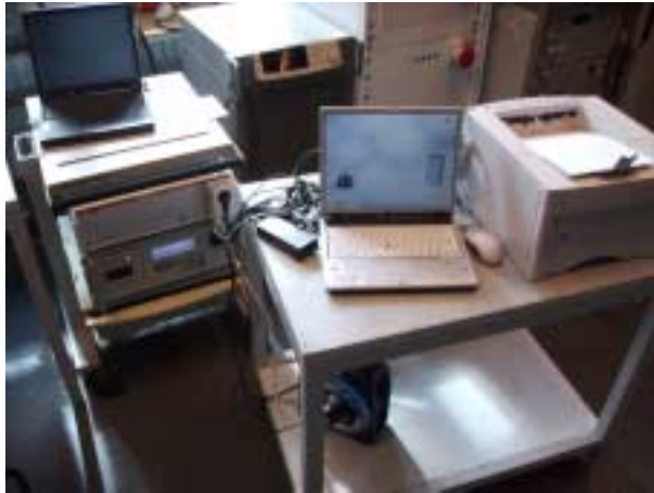
Bild 2-9 Testaufbau zur Messung der Oberschwingungsströme
