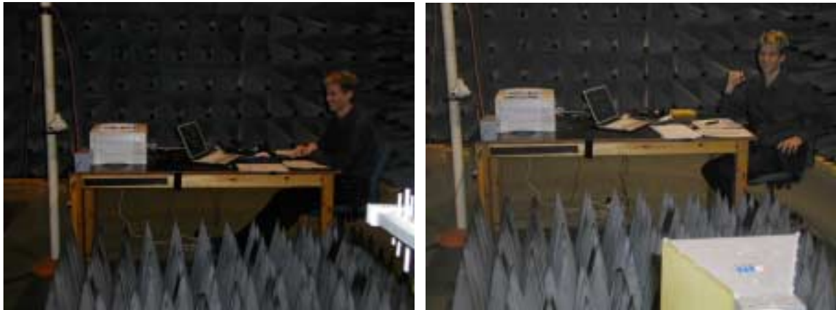
Bild 3-2: Testaufbau für gestrahlte Störfestigkeit
