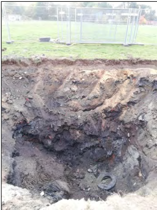
Abbildung 4: Aushubmaterial westlicher Baggerschurf (Schurf 1), 09.10.2018
