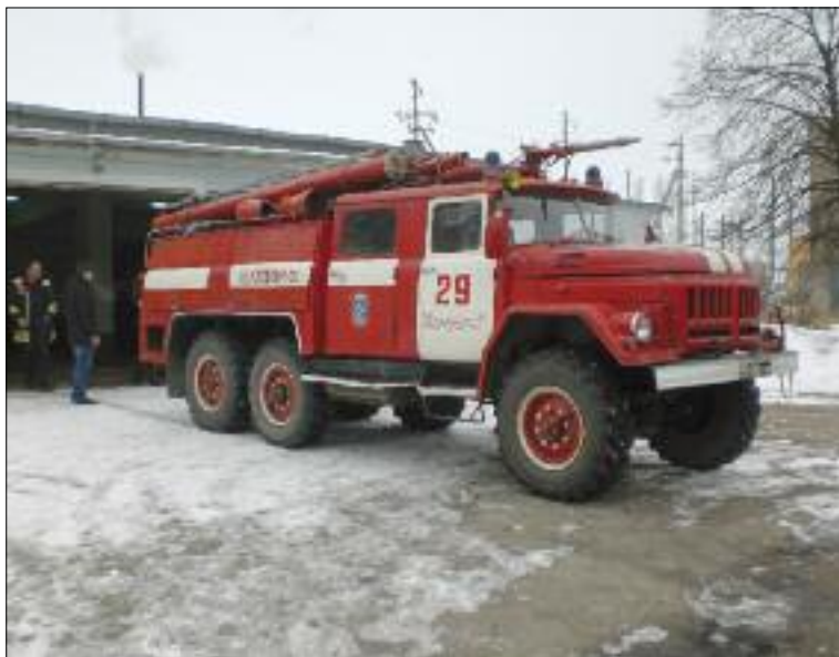
Betagtes: Das Tanklöschfahrzeug SIL wurde 1969 in Dienst gestellt. Mit einem Gesamtgewicht von 10 Tonnen wird es von einem 170 PS starken Benzinmotor angetrieben. Sein Wassertank fasst 2.400 Liter, seine Pumpen schaffen 2.400 Liter in der Minute. Rechts: Eine Einstufige Feuerlöschkreiselpumpe (2.800 Liter/min bei 6 bar), die seit 1960 bis heute gebaut wird
