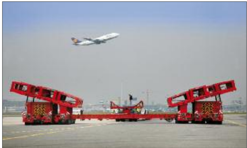
Bärenstarke Hydraulik: Mit dem ARTS-2 X ist im Notfall auch die Bergung eines A380 möglich
