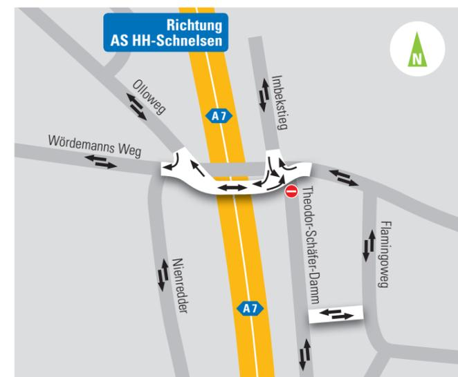
Abb. 2: Verkehrsführung mit Behelfsbrücke im Verlauf Wördemanns Weg
