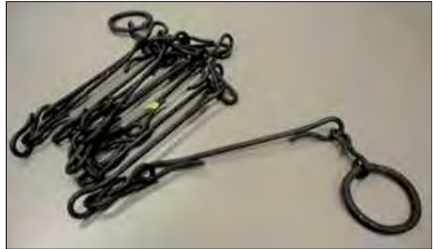
Abbildung 10: Beispiel einer Messkette
