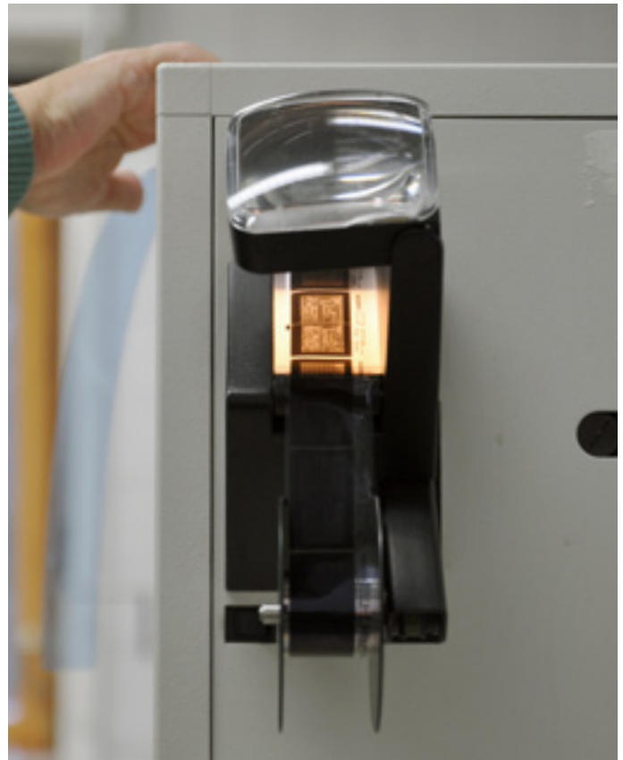
Analoge Prüfung des entwickelten Mikrofilms im Labor mittels eines Vergrößerungsglases
