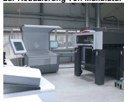
Der Leitstand mit Imagecontrol zur Reduzierung von Makulatur
