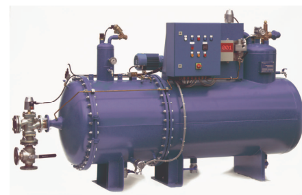
MPEB 10, Leistung 10m 3 /h Restölgehalt < 15 ppm
