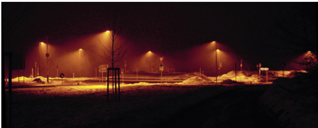
Abb. 16: Vollabgeschirmte, bernsteinfarbene Beleuchtung mit 2200 K Farbtemperatur an einem Kreisverkehr auf der Wasserkuppe in der Rhön. Foto: Andreas Hänel
