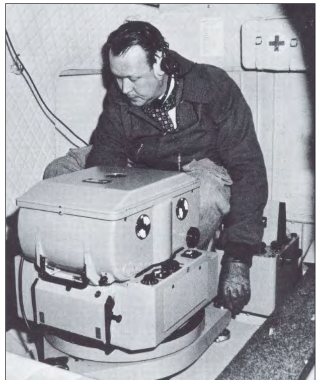
Eine Reihenbildmesskammer (Film) im Flugzeug; um 1970
