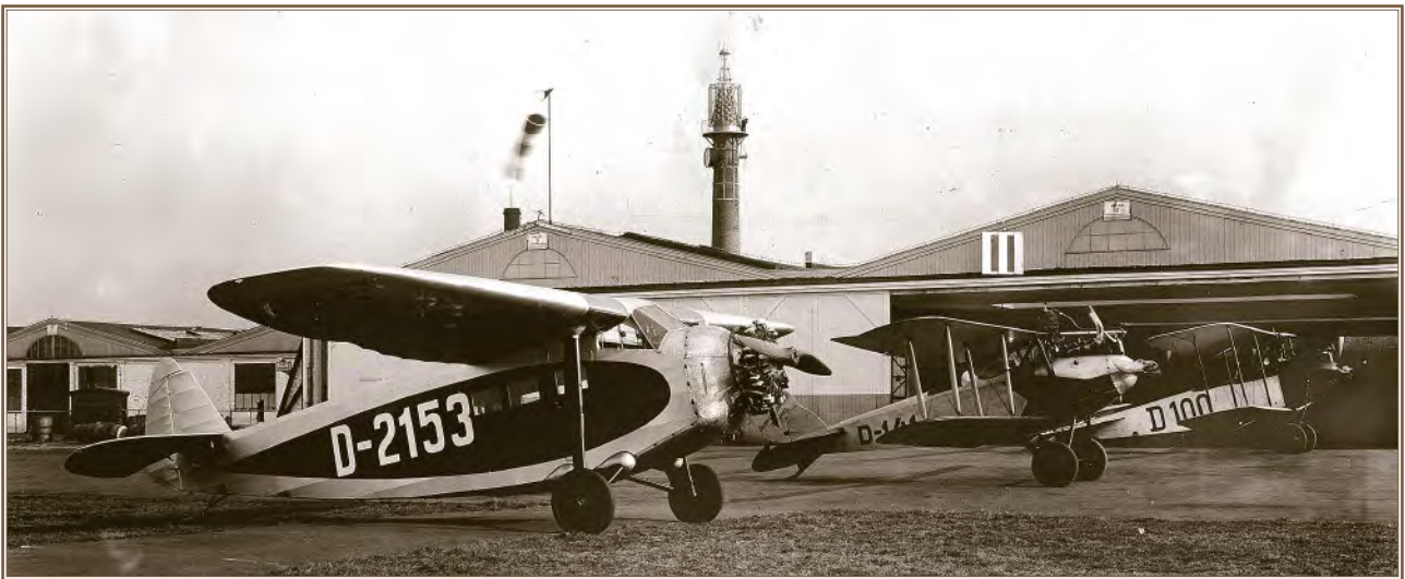
1931: Die drei Flugzeuge des Vermessungsamtes Hamburg vor den Flugzeughallen in Fuhlsbüttel (v.l.n.r.): Eine Focke-Wulf A33 (mit der Kennung D-2153), die L.V.G. C VI (D-141) und die RU. C/1 (D-100). Im Hintergrund der Haltemast für Luftschiffe!
