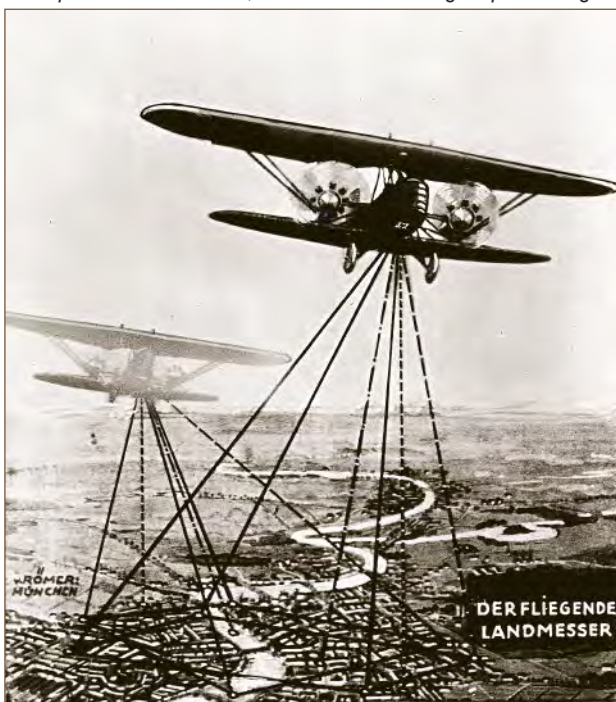
Prinzip der Luftaufnahme, wie es eine alte Negativplatte zeigt
