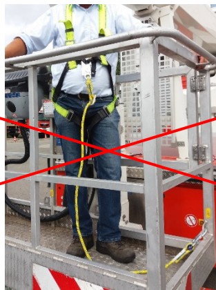
Rückhalteseil zu lang
