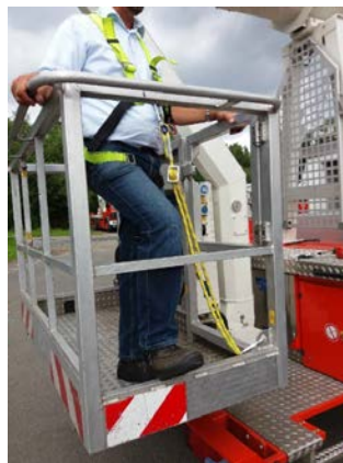
Rückhalteseil kurz eingestellt
