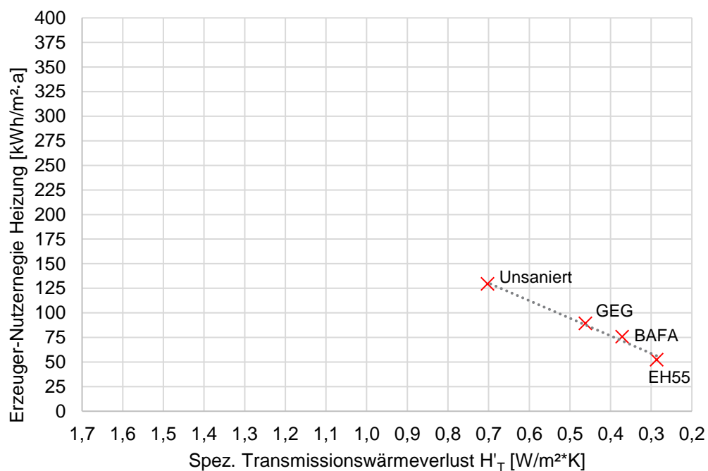
Abbildung 27: Erzeuger-Nutzenergie im Sanierungsverlauf beim MFH-I, eigene Darstellung
